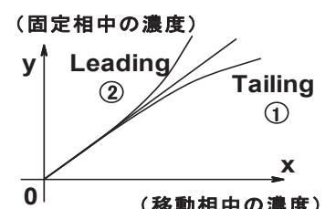
**スポットのテーリングとリーディング:** 移動相と固定相の物質の濃度比は、物質量が少なければ直線的でスポットは縦長の○形だが、量が多いと直線から外れてテーリング(△形)やリーディング(□形)をおこす。
